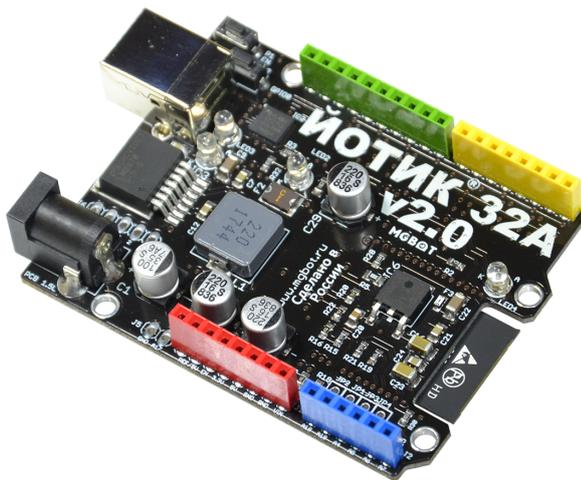
Рис. 2: Внешний вид контроллера ЙоТик 32 v2.0
